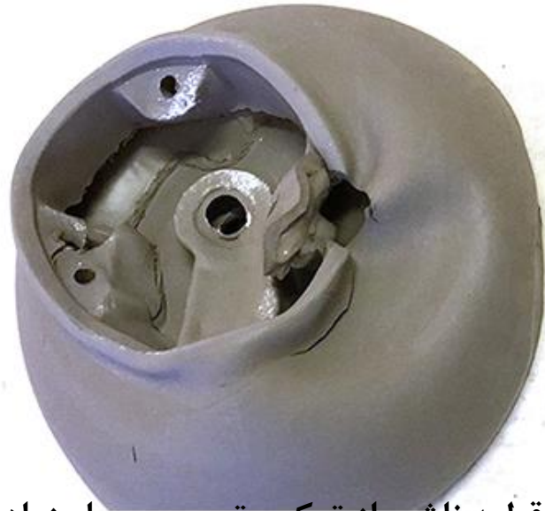
پس زدن قطعه ناشی از تیکسوتروپی بسیار زیاد دوغاب دفرمه شدن
