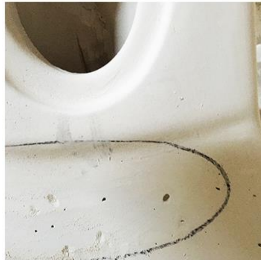
ایجاد سوراخ به دلیل گرانیروی زیاد دوغاب و گیر افتادن حباب های هوا در دیواره مجاور قالب
