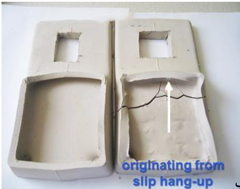
تردی و شکنندگی قطعه ناشی از تیکسوتروپی بیسار کم دوغاب
